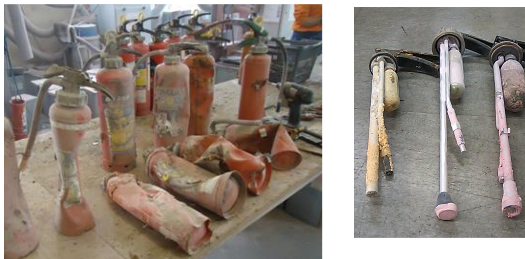
図 5-2 回収した被災消火器の外観(左)と内部(右)
