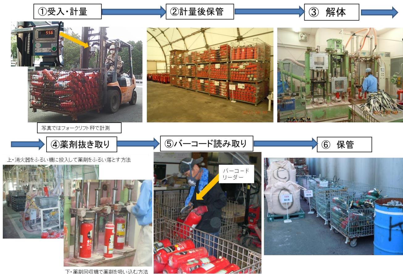
図 3-2 中間処理施設における廃消火器処理の流れ（例）
